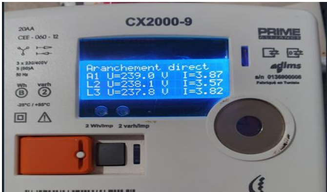
Figure 2 : Mesure avec le branchement direct du compteur
