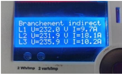
Figure 3. Mesure avec le branchement indirect du compteur
