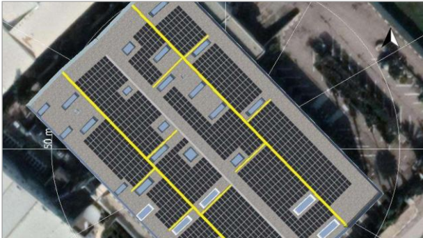
Fig. 5 Vue de dessus de l'installation PV du client
